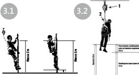
В качестве системы безопасности, в случае, если запас высоты менее 6 м, должны использоваться средства защиты ползункового типа на жесткой анкерной линии (схема 3.1) или средством защиты от падения втягивающего типа (схема 3.2).
