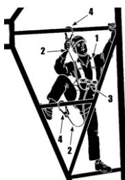
Система канатного доступа обеспечивает работнику доступ к рабочему месту и возврат обратно, выход на поверхность площадки и изменение в рабочей позиции, предоставляет опору и позиционирование, защищая от падения, обеспечивая при необходимости спасение с высоты.
