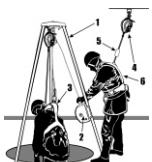
Система спасения и эвакуации, использующая переносное временное анкерное устройство.
