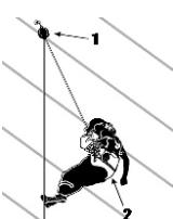
Система спасения и эвакуации, использующая индивидуальное спасательное устройство (ИСУ), предназначенное для спасения работника с высоты самостоятельно.
